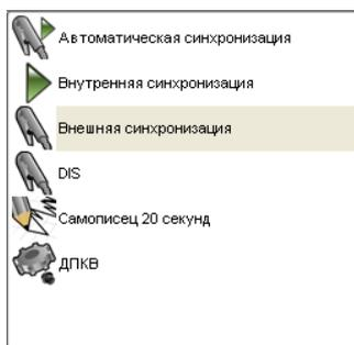
**«Синхронизация»** - позволяет выбрать режим синхронизации от какого-либо датчика, например, датчика первого цилиндра, датчика Холла, датчика коленвала и т.д. Для выбора того или иного режима нажмите левой кнопкой мыши на соответствующем названии вида синхронизации.
