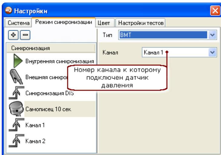
Этот тип синхронизации необходим если нужно синхронизироваться по BMT. В качестве источника сигнала необходимо указать канал где подключен датчик давления. Синхронизация будет происходить в точке максимума давления.
