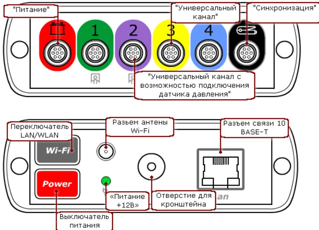
Переключатель LAN/WLAN задаёт тип связи сканера с компьютером.
