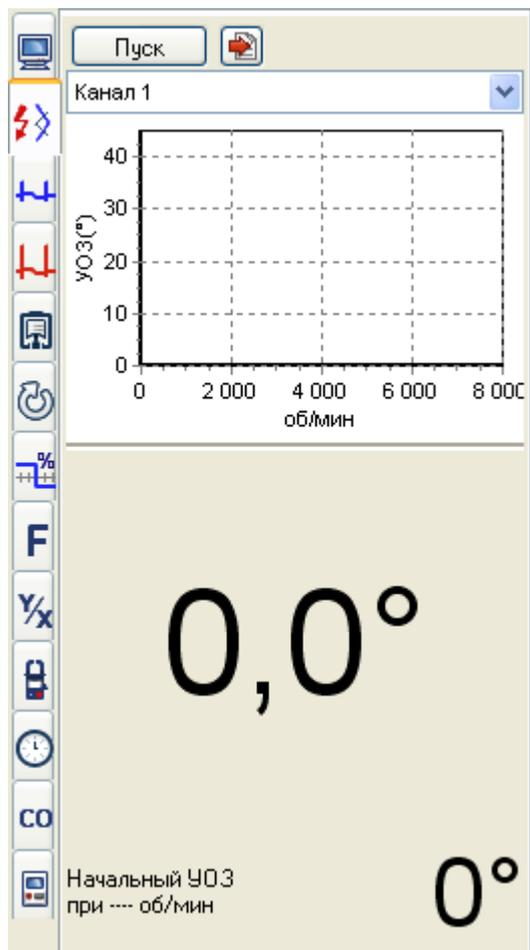
Эта закладка позволяет просмотреть угол опережения зажигания (УОЗ), а также, увидеть его изменение от оборотов двигателя.
