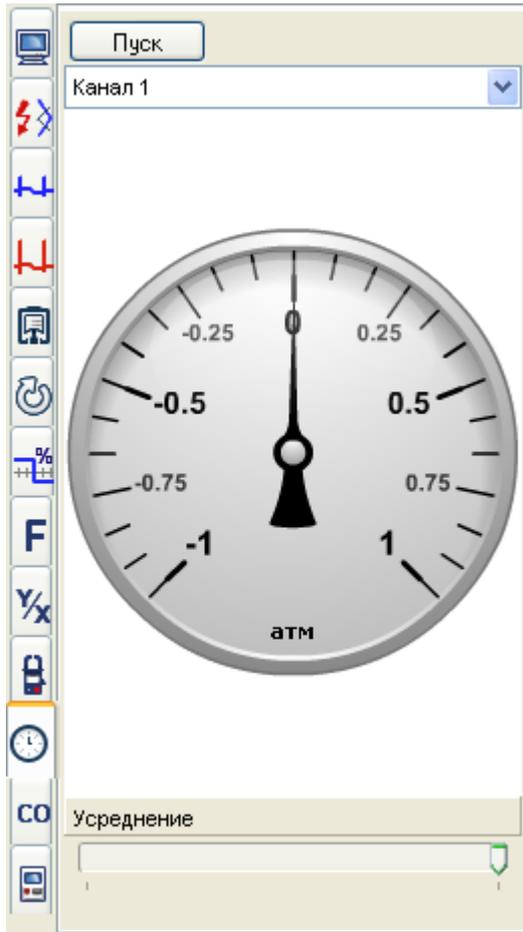
Эта закладка отображает изменение вакуума в привычной форме – в виде манометра.
