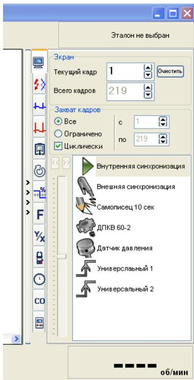
Панель режимов позволяет управлять тестами и режимами синхронизации прибора. Для удобства работы можно изменить размеры панели, а так же быстро свернуть или развернуть её.
