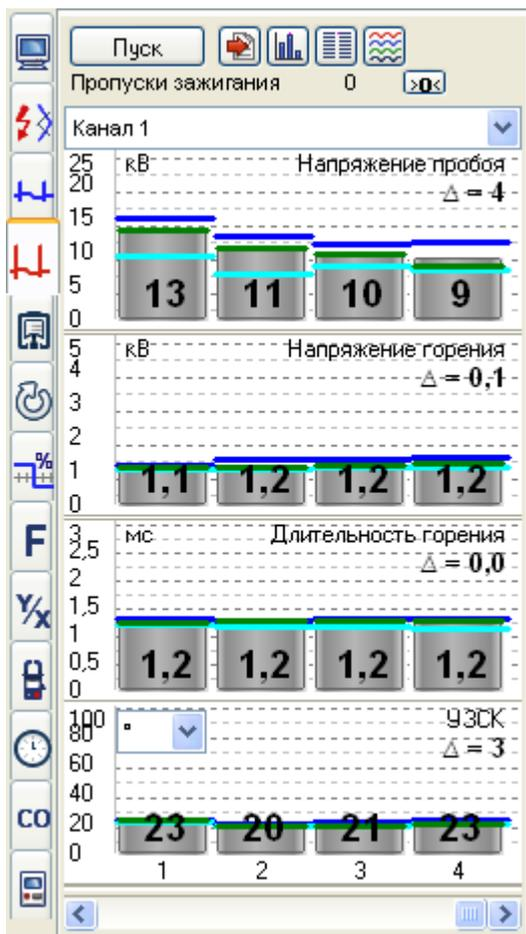
Данная закладка позволяет произвести анализ системы зажигания по вторичному напряжению.
