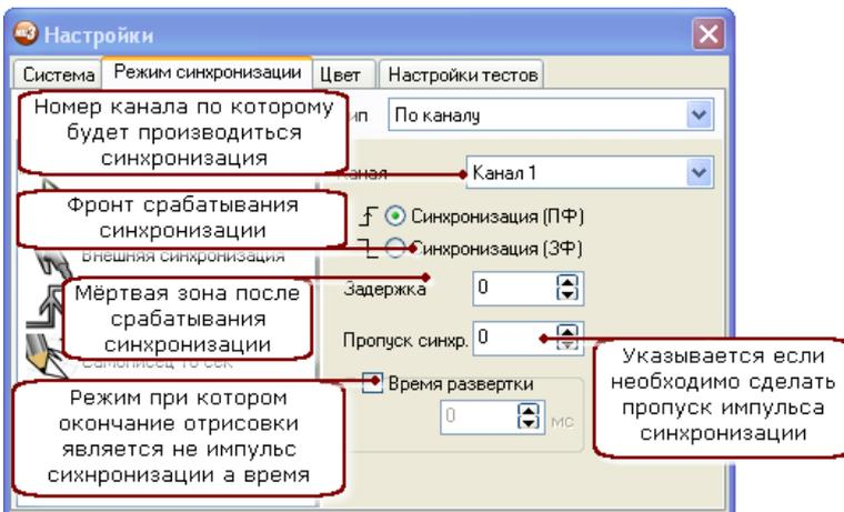
Этот тип синхронизации позволяет произвести синхронизацию по сигналу выбранного канала. Синхронизация происходит при пересечении сигналом уровня синхронизации. Изменить уровень синхронизации можно с помощью регулятора в режиме осциллографа.
