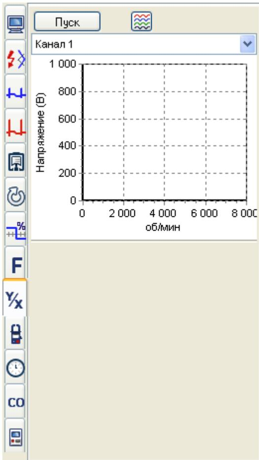
Предназначена для построения графиков изменения напряжения от оборотов. Позволяет оценить работу датчиков, у которых изменение напряжения зависит от изменения оборотов.
