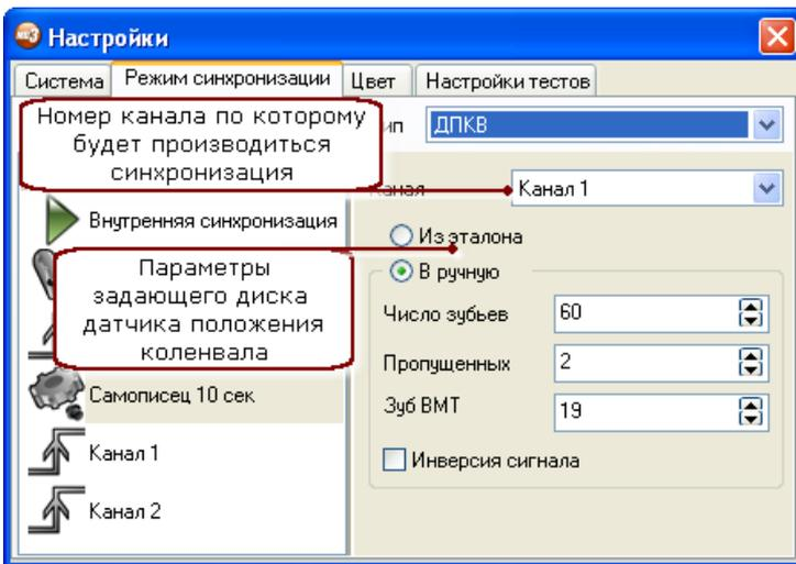
Синхронизация по датчику положения коленвала используется для получения развертки привязанной к ВМТ. Этот тип настройки требует указания параметров задающего диска датчика положения коленвала. Они могут быть взяты из эталонных параметров либо заданы в ручную.
