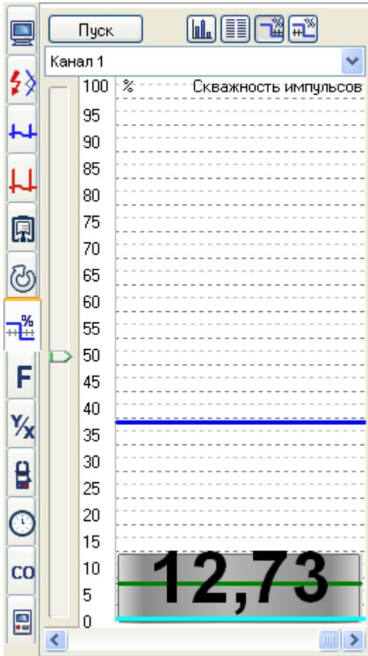
Эта закладка предназначена для определения сквозности импульсов. Сквозность импульса – отношение активного состояния сигнала к периоду. Необходимо, для настройки топливной системы с регулятором холостого хода, выполненного по схеме ШИМ. Например, система KE-Jetronic.
