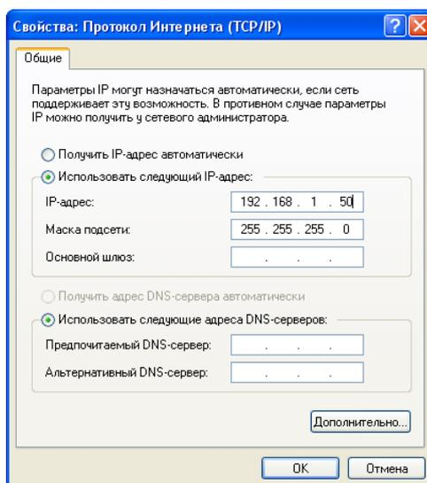
Откройте окно свойств сетевых подключений вашего компьютера. Нажмите кнопку "Свойства". В появившемся окне установите "Использовать следующий IP адрес". Введите IP-адрес **192.168.1.50** и маску подсети **255.255.255.0**. Эти параметры распространяются на сетевую плату компьютера. Вместо цифры «50» IP-адреса Вы можете указать любую цифру, кроме «255» и «4».
