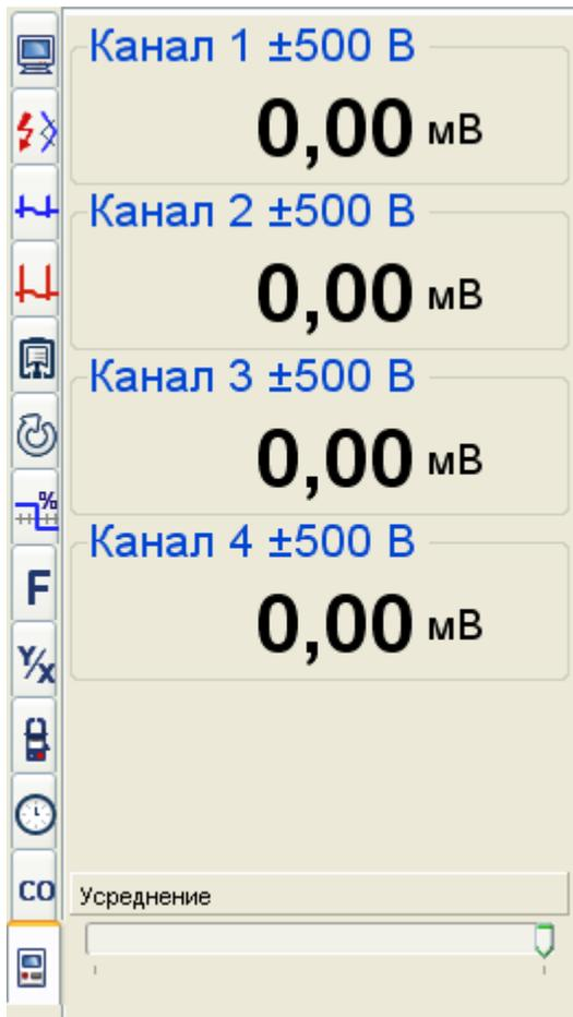
Закладка «**Мультиметр**» предназначена для более удобного просмотра измеряемых значений.
