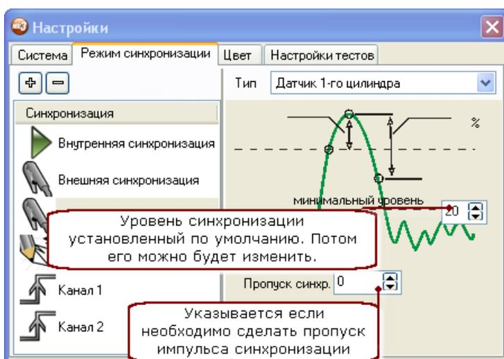
Этот тип синхронизации требует подключения датчика первого цилиндра. Этот тип синхронизации используется для возможности измерения угловых значений фаз газо распределения, для получения оборотов вращения вала двигателя, а так же для определения нумерации цилиндров в осциллограмме.
